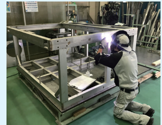
製造現場: 溶接作業
